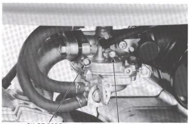
PILOT SCREW THROTTLE STOP SCREW
