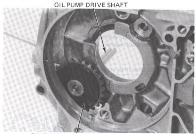
OIL PUMP DRIVE SPROCKET
